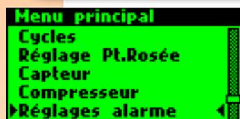
Ce contrôleur est conçu pour être facilement installé, de manière rétroactive, sur la majorité des sècheurs existants sur le marché. Il va permettre de diminuer leur consommation énergétique en asservissant le débit de régénération aux conditions d'exploitation réelles.
